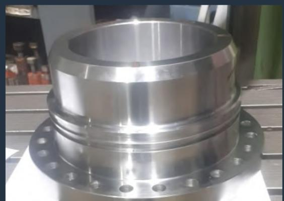
Fabricación de tapas para cilindros de maquinas pesadas
